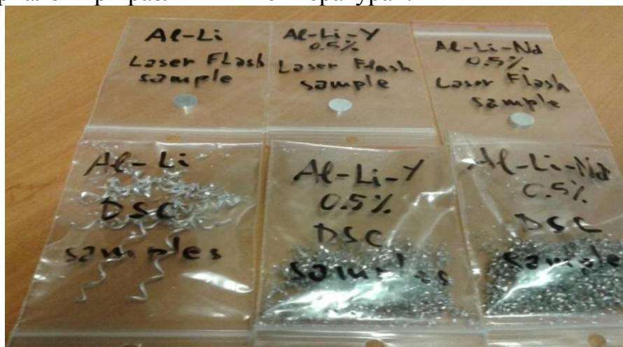
Рисунок 2.14 - Образцы для определения теплофизических свойств алюминиевого сплава Al+6%Li с РЗМ.
