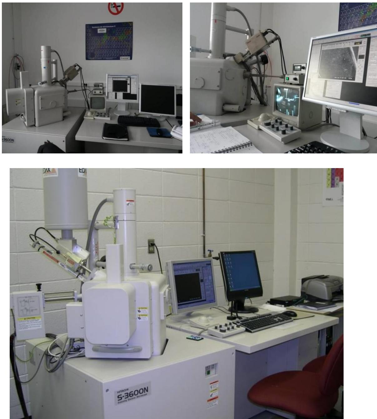
Рисунок 2.1 - Сканирующий электронный микроскоп
