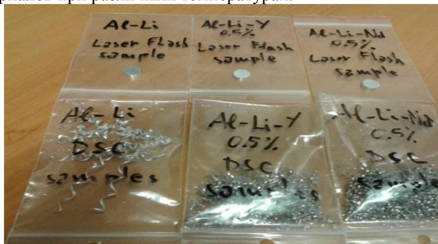
Рисунок 2.14 - Образцы для определения теплофизических свойств алюминиевого сплава  $\text{Al}+6\%\text{Li}$  с РЗМ.
