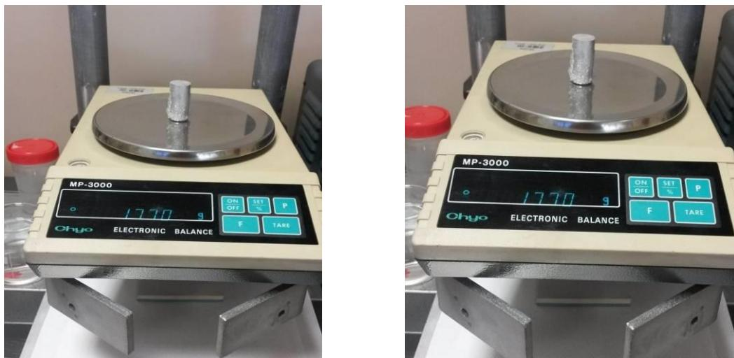
Рисунок 2.16 - Аппарат для определения плотности по методу плавучести (Архимеда).
