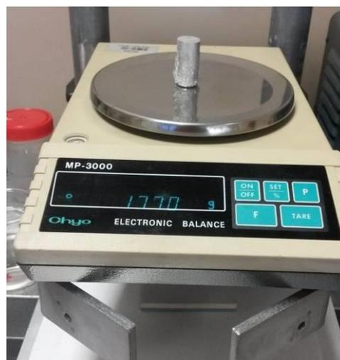
Рисунок 2.16 - Аппарат для определения плотности по методу плавучести (Архимеда).
